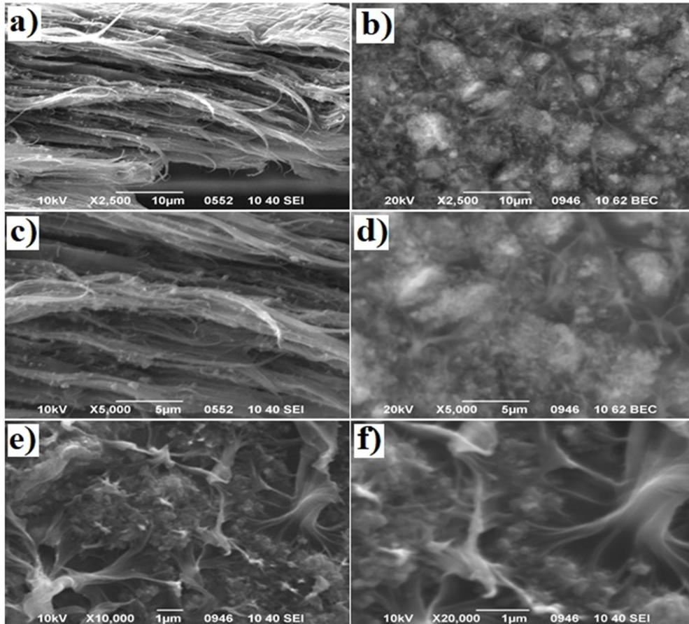
Figure 2. The fracture surface morphologies of HDPE+5%SiO<sub>2</sub> polymer nanocomposite films: (a) and (c) -  $\times 2500$ ; (b) and (d) -  $\times 5000$ ; (e)  $\times 10000$ ; (f)  $\times 20000$ .
